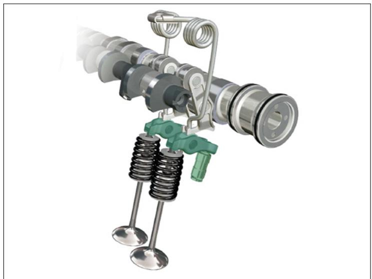
Figura 1: Panoramica completa del sistema Valvetronic BMW
