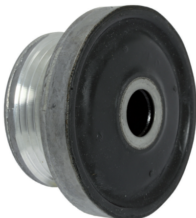
Photo 1 : Vue du dessous de la poulie d'alternateur dont le rôle est d'amortir les vibrations
