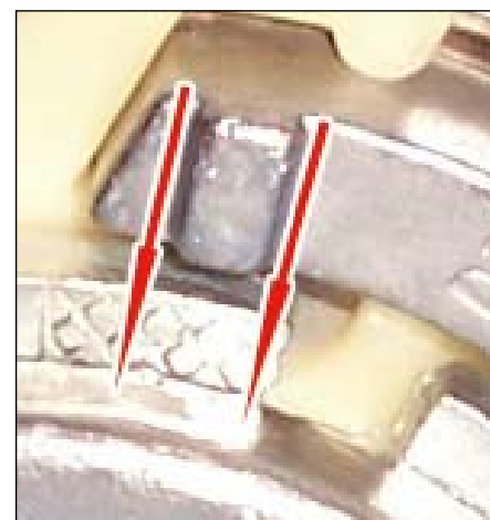
Slika 5: Obe ivice pokazivača stoje mimo zarezu (strelice). Potrebno je korigovati podešenost!
