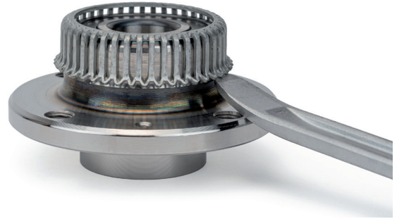
Resim 2: Tekerlek rulmanı, ABS'siz araçlara monte edilecekse sensör bileziği sökülmelidir. Bu işlem levye gibi bir alet kullanılarak yapılabilir.
