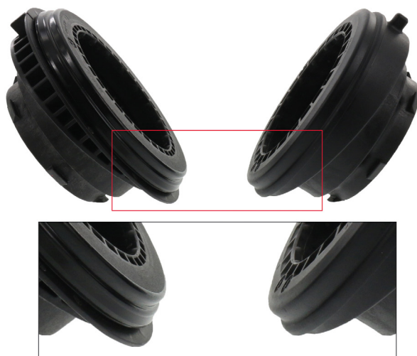
Снимка 1: Опора на амортисьора със защита от пръски (вляво) и без защита (вдясно)
