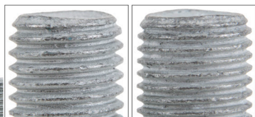
Figura 1: Șurubul din stânga: M12x1,5 Șurubul din dreapta: M12x1,25
