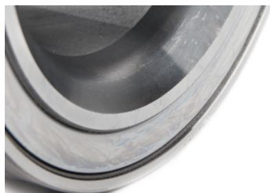
Figura 3: unità mozzo con arrotondamento
