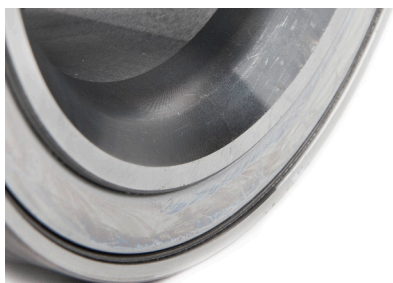
Εικόνα 3: Μονάδα Πλήμνης Φορτηγού με κωνικό άκρο
