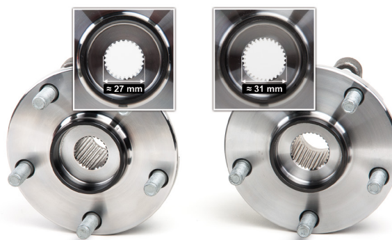
Bild 2: Diametern hos drivknutarnas splines är olika
