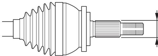
Illustration 1 : Mesurer le diamètre extérieur de l'arbre d'essieu pour identifier le bon roulement de roue.
