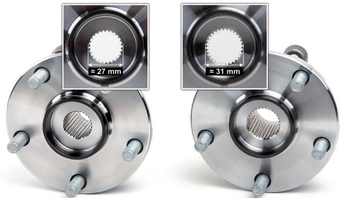
Illustration 2 : Le diamètre du logement de l'arbre d'essieu est différent
