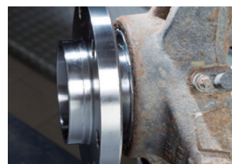
画像 3：ロックリングは必ずステアリングスイベルと同じ高さ
