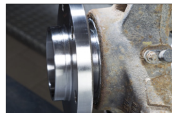
Figura 3: L'anello di sicurezza deve chiudersi a filo con il fuso a snodo
