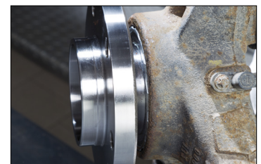
Slika 3: Uskočni prsten mora biti poravnat sa rukavcem kotača
