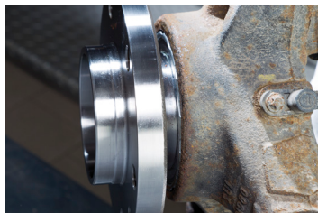
תמונה מס' 3: טבעת הנעילה (ציר קליפס) חייבת להיות מוכנסת בצורה מושלמת לחרוץ שלה ביד הסרן.
