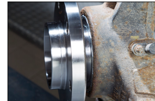
Billede 3: Låseringen skal flugte med styrespindlen
