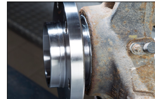
Obrázek 3: Pojistný kroužek musí být v rovině s ramenem nápravy
