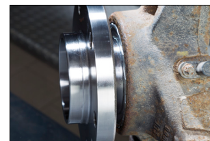
Снимка 3: Заключващия пръстен трябва да лежи наравно с шенкела
