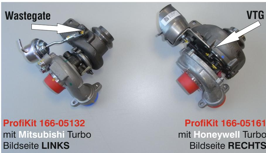
Der markanteste Unterschied beider Turbolader liegt - für den Fachmann leicht zu differenzieren - in Gewicht und der Art der Ladedruckregelung:
