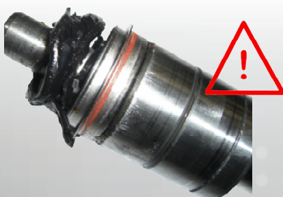
Abb. 1: Überschüssige Dichtmasse hat sich in der Gleitringdichtung abgelagert Folge: Undichtigkeit an der Entwässerungsbohrung
