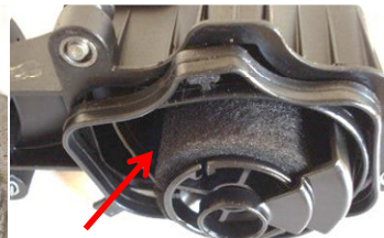
Ölnebelabscheider zugesetzt Wechselintervall neu 45.Tkm! (hier alte Ausführung)
