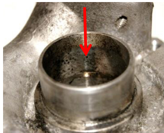
Ölnebeleintrag in das Verdichtergehäuse
