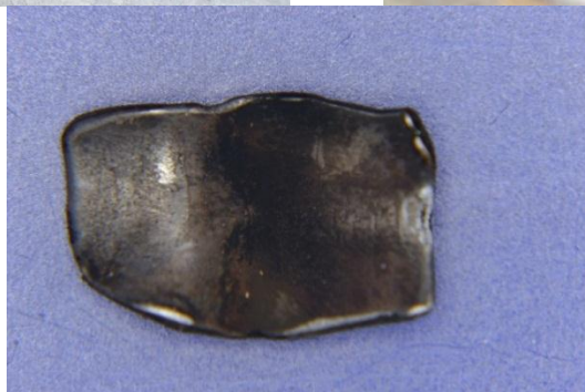
Beispiel für Bruchstücke aus einem Auspuffkrümmer
