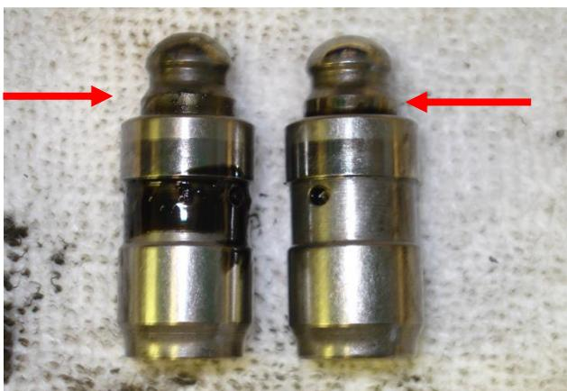
Image 3: Pousoir hydraulique gauche sorti au maximum; les soupapes ne sont pas étanches
