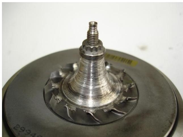
Wird am Verdichterrad ein Fremdkörperschaden (siehe Bilder) festgestellt, müssen folgende Arbeiten durchgeführt werden, um Folgeschäden zu vermeiden:
