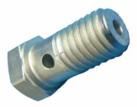
Ein verstopftes Sieb in der Hohlschraube führt auf Grund von reduzierten Öldurchsatz zum vorzeitigen Turboladerschaden durch Mangelschmierung. Mittlerweile werden Hohlschrauben ohne Sieb verbaut.
