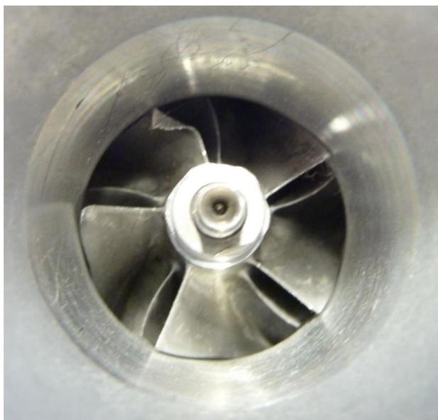
Wenn sich eine Schaufel des Verdichterrades umbiegt (siehe Bild), sollte der gesamte Ansaugbereich geprüft und gereinigt werden.
