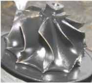
An increased bearing clearance is a consequential damage resulting from the foreign body damage. Ein erhöhtes Lagerspiel ist ein Folgeschaden, der durch den Fremdkörper verursacht wurde. Please, therefore, check the gas inlet edges of the turbine wheel.
