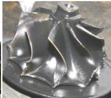
Ein erhöhtes Lagerspiel ist ein Folgeschaden, der durch den Fremdkörper verursacht wurde. Bitte prüfen Sie die Gaseintrittskanten des Turbinenrades. Die Sichtprüfung der Gaseintrittskanten ist bei gutem Licht über die Schaufeln des Turbinenrades vom Turbinenausgang her möglich!
