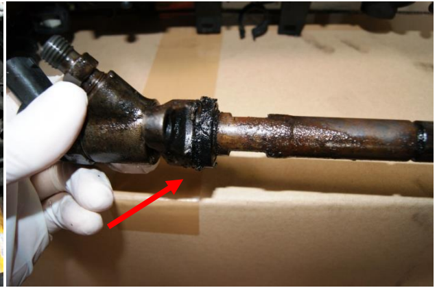
Befecskendezőfej tömítetlenség – új tömítés
