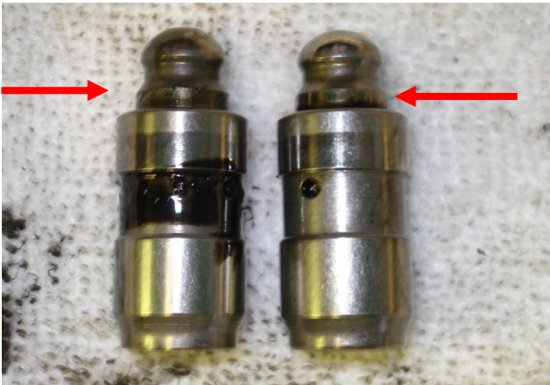
Immagine 3: Punteria idraulica sx. fuoriuscita al massimo, le valvole non sono stagne
