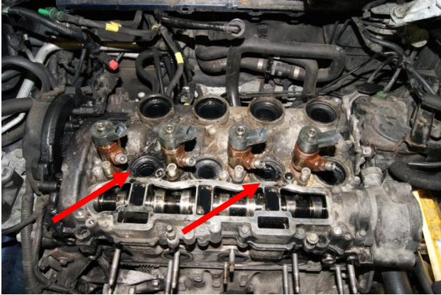
Immagine 1: Fuoriuscita di gas dal collettore di aspirazione
