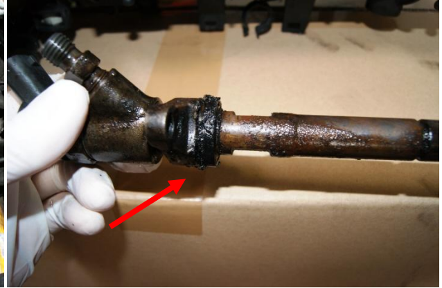
Immagine 2: Supporto del corpo dell'iniettore non stagno
