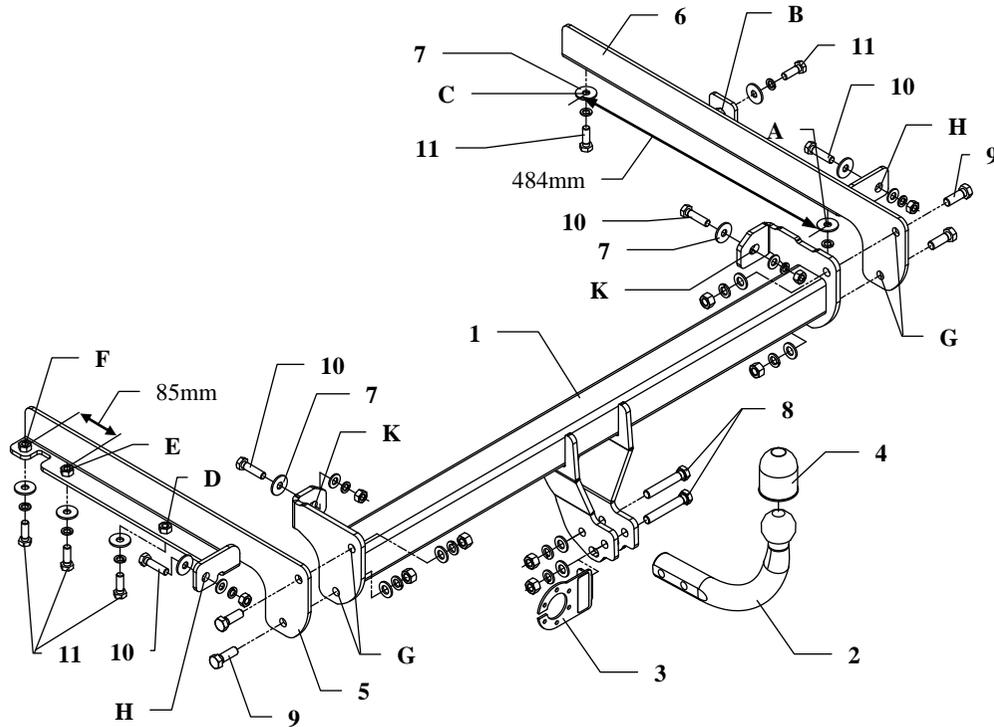
Die Anhängerkupplung (Katalognummer **Y05**) ist für folgende Fahrzeugtypen zugelassen: **HONDA CIVIC COMBO**, ab Bj. 1997 bis 10.2000, dient zum ziehen der Anhänger mit der Gesamtlast von **1300 kg** und der Kugelstützlast von max. **50 kg**.
