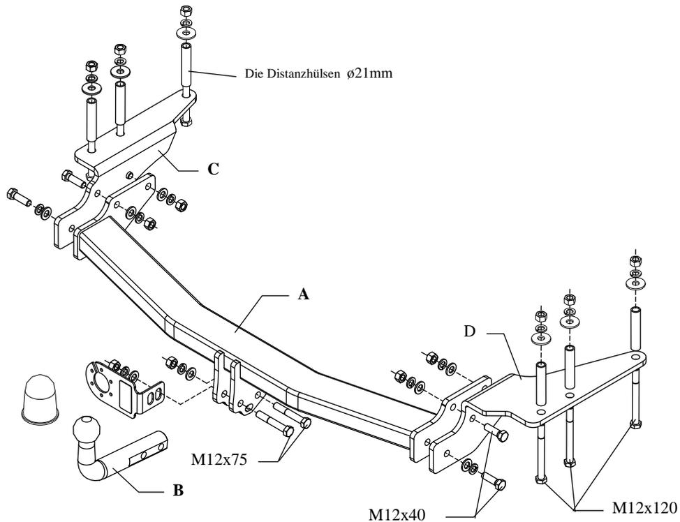
Die Anhängerkupplung (Katalognummer **SY01**) ist für folgende Fahrzeugtypen zugelassen: **SSANG YONG REXTON**, ab Bj. 2002, dient zum ziehen der Anhänger mit der Gesamtlast von **2300 kg** und der Kugelstützlast von max. **140 kg**.
