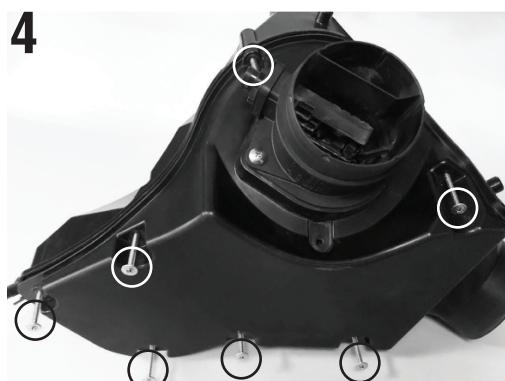
4. Posizionare il filtro montato all'interno del contenitore e avvitare le viti come mostrato in figura 4.
