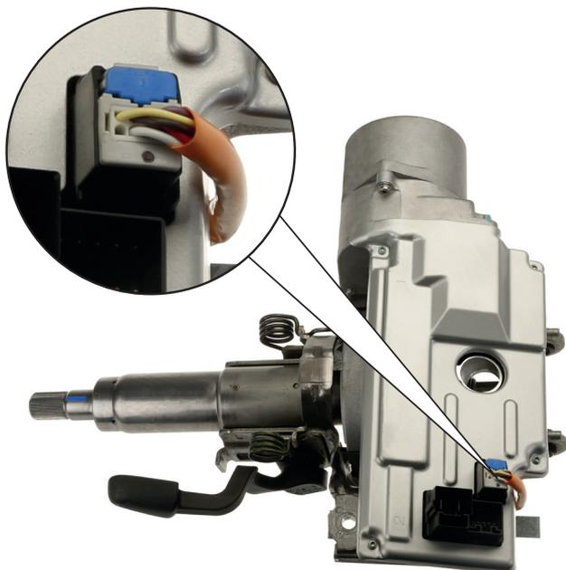
*Colonne de direction avec raccord de capteur externe*
