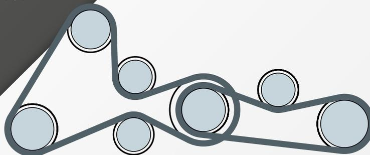
Fig 1 - Diagrama dos componentes auxiliares (até ao motor número 0113089, inclusive), equipado com o tensor 37 93 0167 e correia trapezoidal estriada 37 92 8798.
