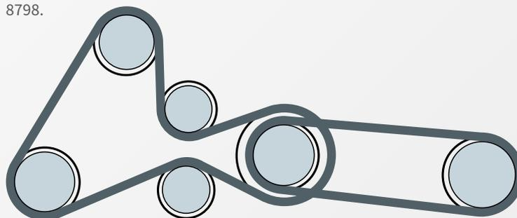
Fig 2 - Diagrama dos componentes auxiliares (desde o motor número 0113090), equipado com a correia trapezoidal estriada 70 94 0717.
