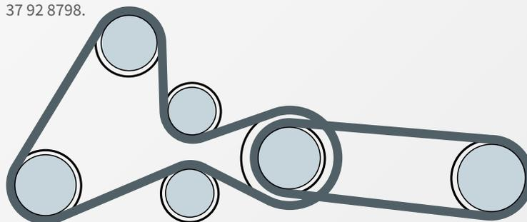
Abb. 2 - Diagramm des Keilrippenriementriebs (ab Motor Nr. 0113090), ausgestattet mit dem elastischen Keilrippenriemen 70 94 0717.
