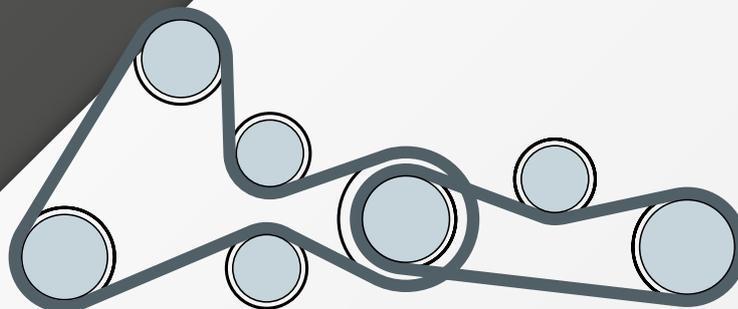
Abb. 1 - Diagramm des Keilrippenriementriebs (bis einschließlich Motor-Nr. 0113089), ausgestattet mit Spannrolle 37 93 0167 und Keilrippenriemen 37 92 8798.
