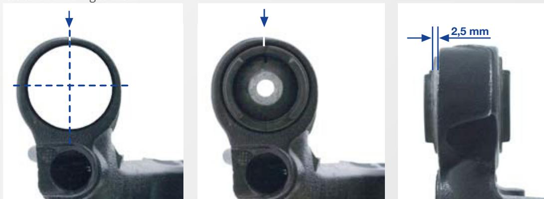
A ranhura do novo casquilho deve ser alinhada com a marcação no braço oscilante e, de seguida, instalado com uma ferramenta especial adequada até o apoio ser pressionado a uma dimensão de 2,5 mm.
