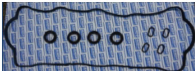
2 Para la colocación de los nuevos retenes de aceite de tapa usaremos el **útil especial** que nos permita **situarlos correctamente nivelados y posicionados**. Posteriormente colocar la **junta en su alojamiento** sin aplicar ningún tipo de sellante en este apartado.
