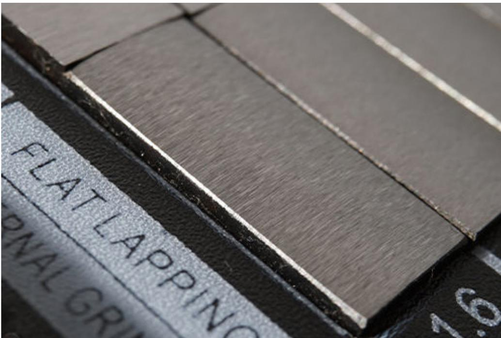
La **rugosidad máxima** ( $R_z$ ) se define como la media aritmética de la altura entre los puntos más altos más bajos de la superficie. Se mide en **micrómetros** ( $\mu\text{m}$ ) y se utiliza para indicar la profundidad de los surcos más profundos en la superficie.
