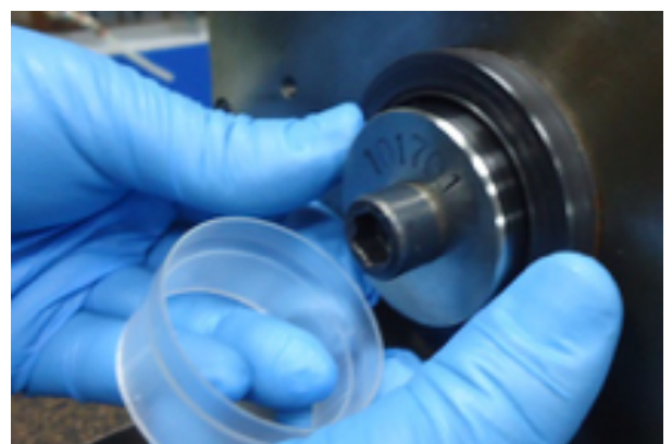
Ensamblaje del retén PTFE en su alojamiento
