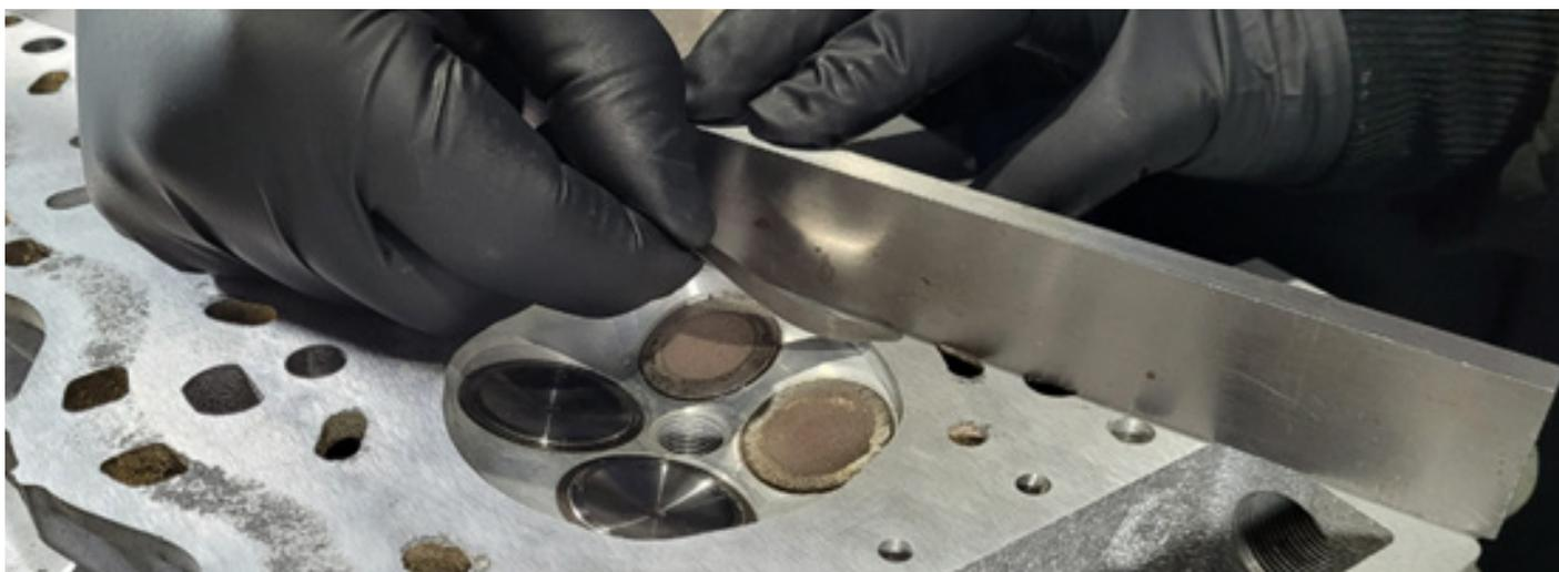
En caso de que hubiera una **deformación mayor** de lo permitido, la culata y/o el bloque deben **ser rectificadas**. En caso de rectificar el bloque, mediremos la altura del pistón con respecto al plano del bloque para determinar el espesor de la junta de culata a utilizar.
