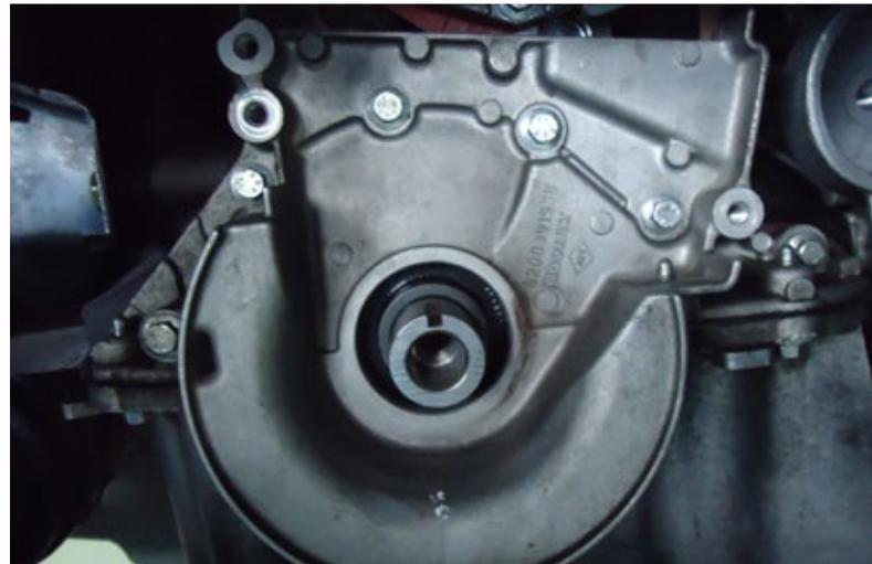
**10** Montar la **correa de la distribución**, accesorias y **todos aquellos componentes que fueron desmontados**, siguiendo las especificaciones que se detallan en el manual de reparación del fabricante.
