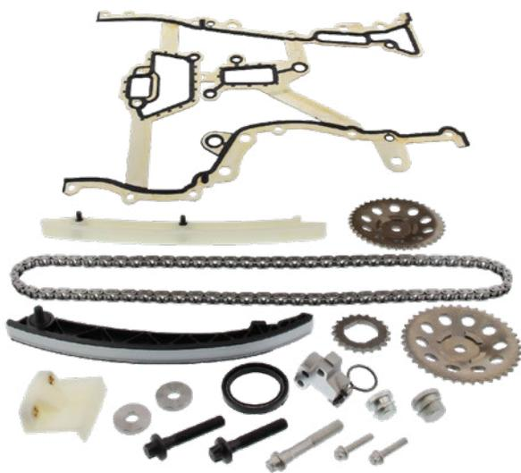
... dennoch unterliegt auch die Steuerkette dem Verschleiß. Sie kann reißen oder einzelne Zähne der Nockenwellenräder oder des Kurbelwellenrades überspringen. Die Folge: Motorschaden. Kettenrasseln beim Start, Rasseln und Klackern im Leerlauf, unruhig laufender Motor, Aufleuchten der Motorkontrolllampe – all das können Anzeichen einer defekten Steuerkette sein.
