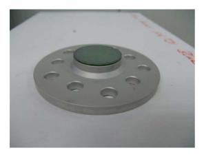
Distanzscheibe montieren / mount the wheelspacer
