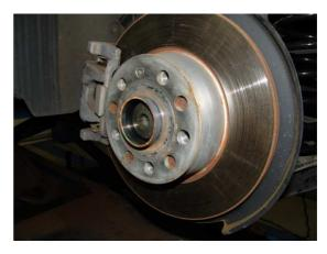
Fettkappe auf Distanzscheibe stecken / put the grease cap on the wheelspacer
