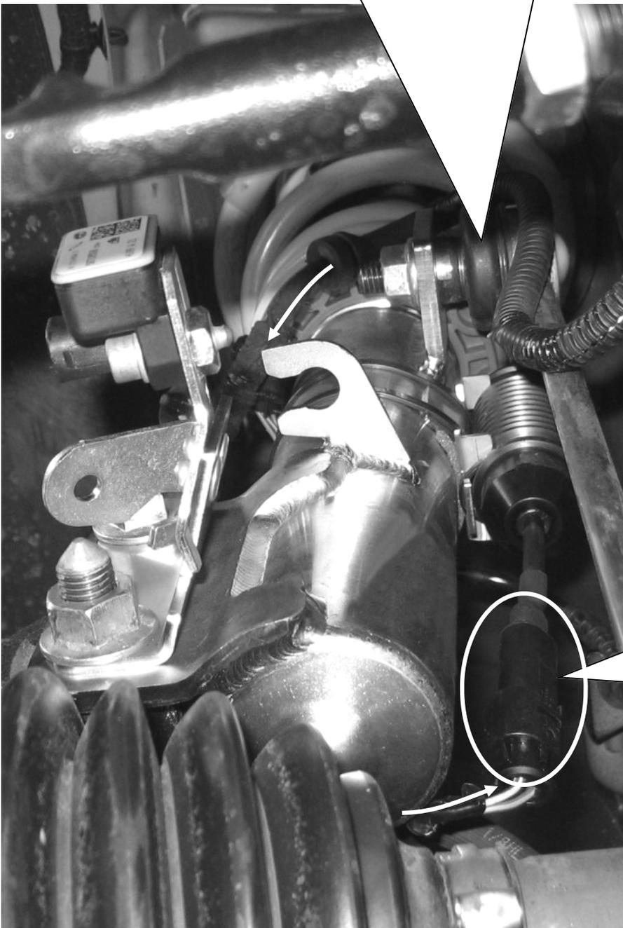
Originale Dämpfersteuerungsleitung um das Federbein herum verlegen und evtl. mit Kabelbindern befestigen.
