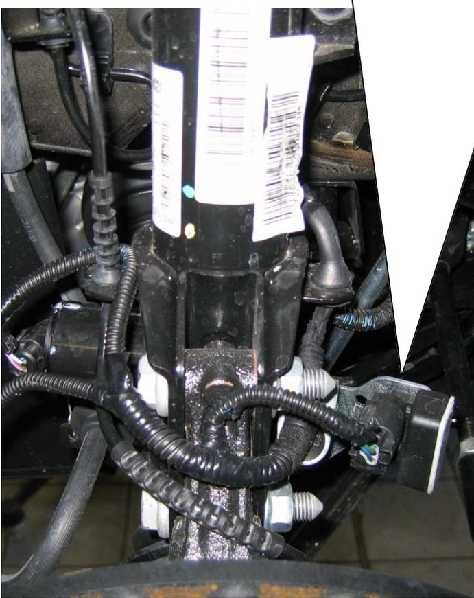
Mitgelieferte Halterung an das neue Federbein montieren. Steuergerät mit Schrauben oder Nieten an der Halterung befestigen
