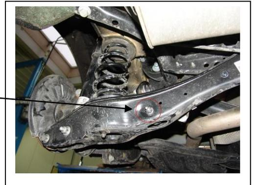
13. Halter für Niveaugeber am Querlenker links demontieren
