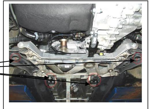
10. Kabelführung am Achsträger links ausclipsen (etwa in Höhe der Antriebswelle links).
