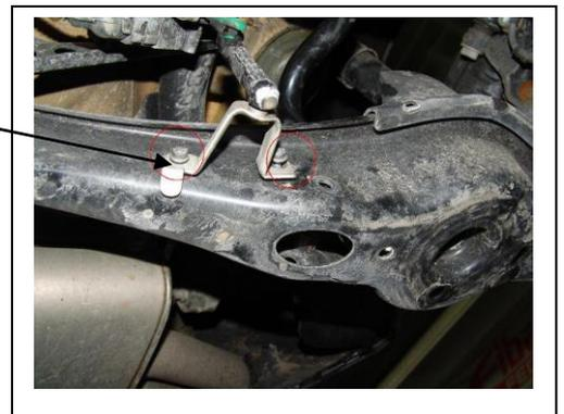
14. Feder links ausbauen, dazu Feder mit geeignetem Werkzeug vorspannen, Stoßdämpferbefestigung unten und Querlenkeranbindung unten lösen (ACHTUNG: Vorspannung der Feder beachten, Verletzungsgefahr!!) Gelösten Querlenker ggf. unterstützen !
