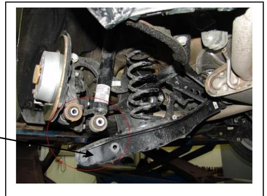
15. Auspuffenschalldämpfer links und rechts lösen (2x SW13) und mit geeignetem Mittel abstützen, Auspuffanlage etwa 5cm absenken.
