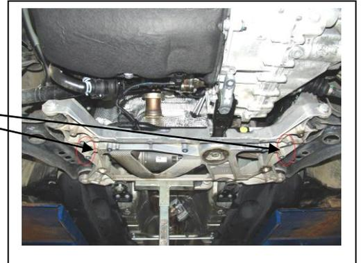
09. Achsträger in geeigneter Weise abstützen und Befestigungsschrauben lösen (4 x SW18) und Versteifungs-/Halteblech hinten (4 x SW13) demontieren.
