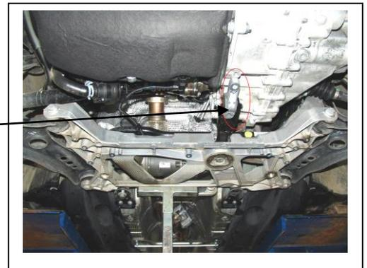
06. Auspuffhalterung am Achsträger lösen (2 x SW13)
