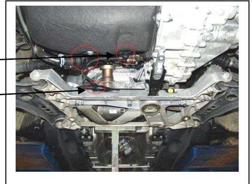
05. Drehmomentstütze Getriebe lösen (2 x SW16).
