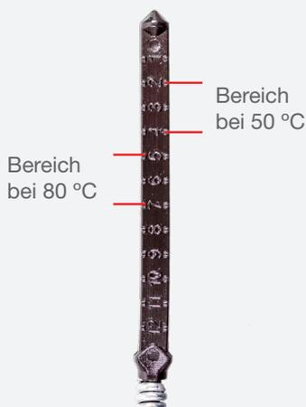
Nach der Messung des Ölstandes den Ölpeilstab unbedingt entfernen!
