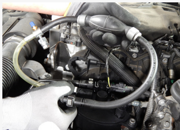
Figura 2 Ferramenta de purga do sistema de combustível instalada e pronta a utilizar
