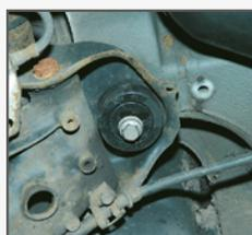
Os casquilhos vulcanizados da estrutura da suspensão traseira falham após determinada quilometragem e não podem ser substituídos. A febi oferece uma solução de reparação rápida, que não requer a substituição da estrutura da suspensão traseira por completo e, portanto, poupa tempo e dinheiro:
