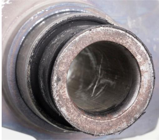
**DE** Durch eine mechanische Behandlung der Lagerflächen wird der Korrosionsschutz entfernt. Diese Behandlung wird durchgeführt um die Anlagefläche der Schraube zu vergrößern. Das Vorhandensein von Rost ist abhängig von der Lagerzeit / Luftfeuchtigkeit und beeinträchtigt nicht die Funktion der Produkte. Ein nachträglicher Schutz der Oberflächen kann zu einer Funktionsbeeinträchtigung führen.
