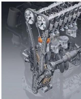
I kit Marelli MCK1150 e MCK1190 sono pensati per la completa manutenzione della distribuzione a catena di autovetture del gruppo VAG con motori TSI-TFSI ad iniezione diretta di benzina, con cilindrata 1800 e 2000 cc., con potenze da 88 kW a 155 kW, prodotte dal 2007 al 2017.
